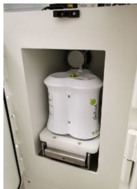
Le générateur de Gallium-68 dans l'enceinte blindée
